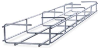
Bei der vertikalen Installation von Kabeln können diese ohne weitere Befestigung in der Standard-Version des Gitter-Kanals herausfallen. Um das zu verhindern, verwendet man die Ausführung in Z-Form, die durch ihre besondere Konstruktion die Kabel hält.
